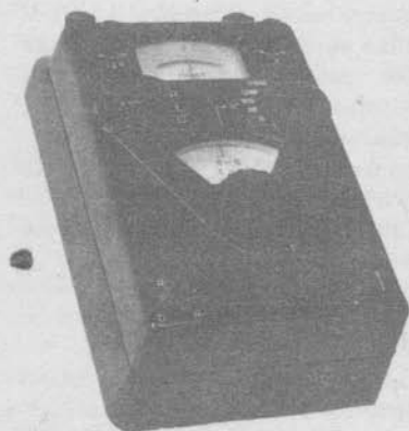
Obr. 199. Icomet — prenosný prístroj na meranie odporov, indukčností a kapacít (Metra Blansko)
