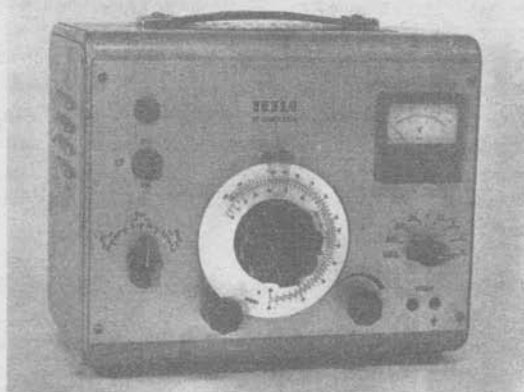
Obr. 201. Nízkofrekvenčný RC generátor Tesla BM 365 (20 Hz až 1,2 MHz)
