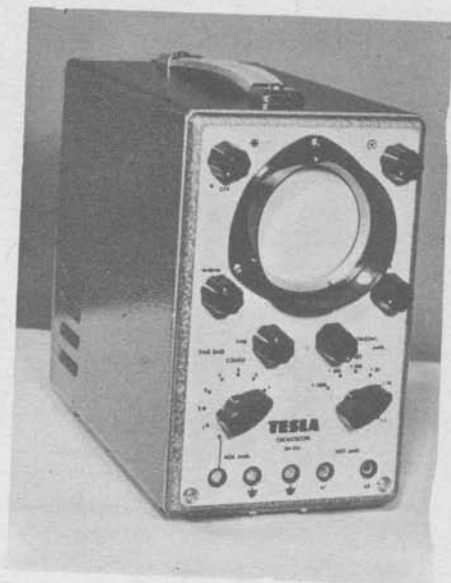
Obr. 223. Malý prenosný osciloskop s obrazovkou \varnothing 7 cm Tesla BM 370
