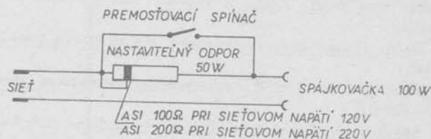
Obr. 297. Prípravok na zníženie výkonu spájkovačky použitím predradeného odporu, ktorý možno skratovať spínačom (úsporné zapojenie)
