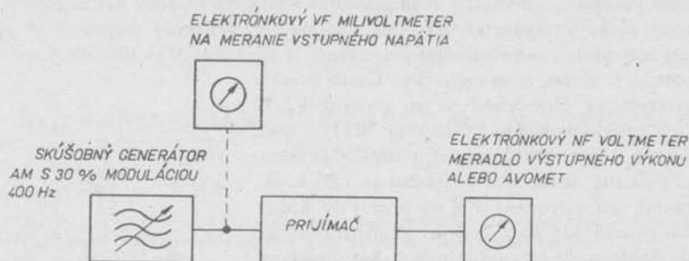
Obr. 162. Bloková schéma na meranie vf citlivosti AM prijímačov (modulácia 400, resp. 1000 Hz)
