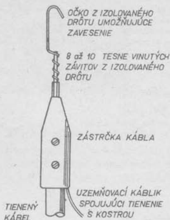
Obr. 155. Očko z izolovaného drôtu na voľné naviazanie kábla vyslača
