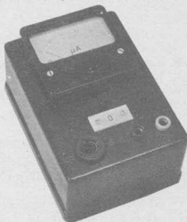
Obr. 246. Jednoduchý tranzistorový voltmeter s vnútorným odporom asi 100 \text{ k}\Omega/\text{V} . Nulu prístroja možno prepnutím prepínača posunúť v prípade potreby do stredu stupnice
