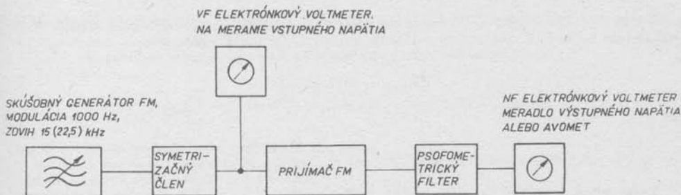
Obr. 166. Bloková schéma merania vf citlivosti FM prijímača s obmedzeným šumom pri použití symetri-začného člena (pozri obr. 161) a psofometrického filtra (pozri obr. 167)
