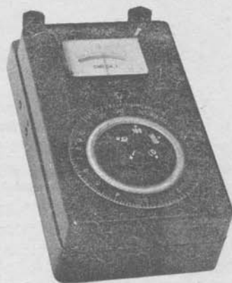
Obr. 198. Odporový mostík Omega I (Metra Blansko) 0,05 \Omega až 50 k \Omega
