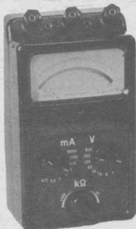
Obr. 6. Univerzálny merací prístroj DU 10 (Metra Blansko). Napätové rozsahy 3 až 600 V; vnútorný odpor na jednosmerných rozsahoch 50 k \Omega/V , na striedavých 16,6 k \Omega/V . Prúdové rozsahy 0,12 mA až 6 A. Možnosť merania odporov v dvoch rozsahoch
