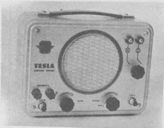
Obr. 221. Sledovač signálov BS 367 (Tesla Brno). V prístroji je zamontovaný tiež multivibrátor a žiarovková skúšaciu
