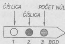
Obr. 306. Označenie kondenzátorov tromi bodmi
