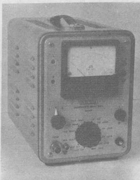
Obr. 196. Milivoltmeter Tesla BM 384 (20 Hz až 3 MHz)
